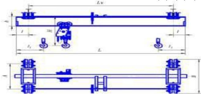
Краны подвесные ручные однобалочные предназначены для подъема и перемещения груза в помещениях или под навесом при температуре окружающей среды от -40° до +40°С. Изготавливаются общепромышленного, взрывоопасного и пожаробезопасного исполнения, для холодного, умеренного климата. Имеется сертификат Соответствия. Тяговое усилие механизма передвижения крана — 190 Н.
