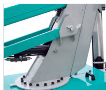
Все гидравлические механизмы платформы установлены на головной секции стрелы.
