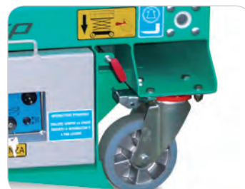
Фиксатор ведущих колес для перемещения по прямой линии
